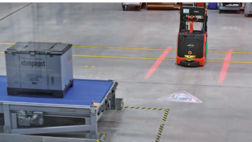
Automatisiertes Fahrzeug des Typs «L-Matic» von Linde Material Handling im Arbeitseinsatz.
