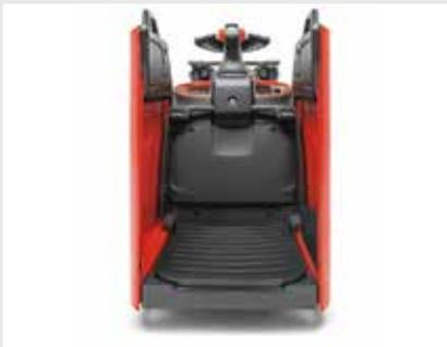
Telaio in acciaio per proteggere il conducente
