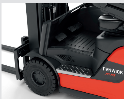
Marche d'accès plus large et plus basse
