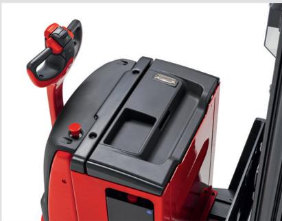
Alle Bedienelemente an ergonomischer Deichsel können problemlos mit einer Hand bedient werden
