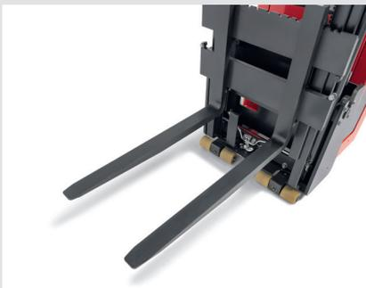
Durch die ISO-genormten Gabelzinken kann das Fahrzeug alle Palettentypen aufnehmen
