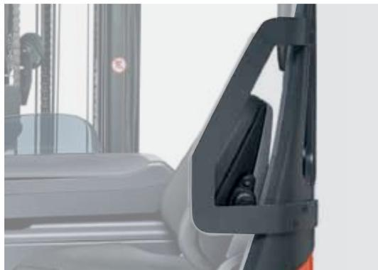
**Seitlicher Schulter-Schutzbügel** für eine rundum geschützte Fahrerkabine beim Arbeiten in engen Regalgängen.
