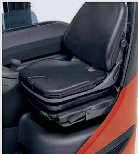
**Der luftgefederte Fahrersitz** wählt automatisch den optimalen Federweg passend zum Gewicht des Fahrers.
