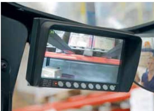
**Vision-Paket** für verbesserte Sicht durch die innovative Kamera an Fahrerschutzdach und Mast.
