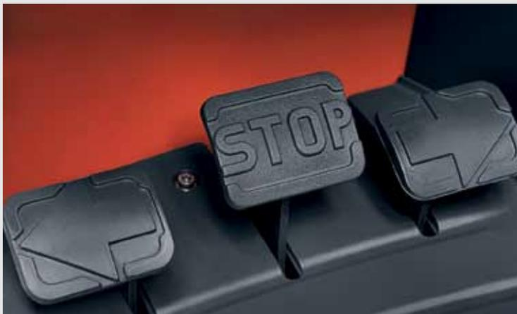
**Linde Doppelpedal.** Einfaches und schnelles Rangieren ohne Umsetzen der Füße.
