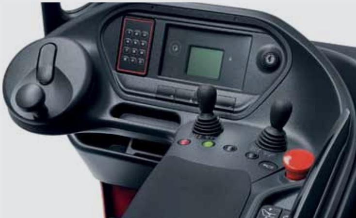
**Feinfühlige und präzise Steuerung** der Hubfunktionen mit den Fingerspitzen.
